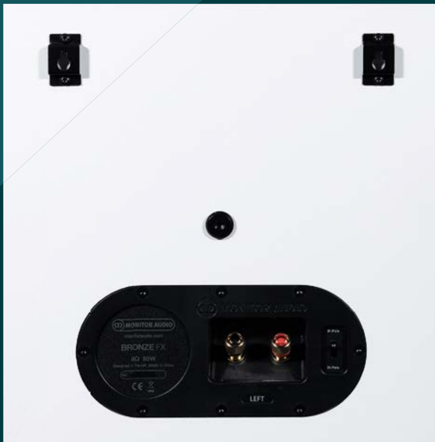
Der Bronze FX lässt sich mittels Kippschalter zwischen Bi-Pol- und Di-Pol-Betrieb umschalten, wobei im Di-Pol-Modus einer der beiden Hochtöner in der Phase gedreht wird um ein diffuseres Klangbild zu erzeugen
